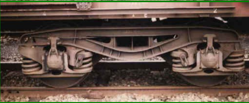
Bogie Y 31, empattement de 1.80 m, roue de 840 de diamètre sauf pour le type Y 31 C1 qui ont un diamètre de 760 mm. C'est LE bogie du wagon kangourou (Roco)
