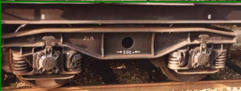
Bogie Y 21 soudé, empattement de 2.00 m, roues de 920 mm, visibles surtout sous les citernes, etc...
