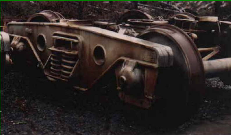
bogie ANF 20 C. Abandonné quasiment de nos jours car sa masse non suspendue est très élevée.
