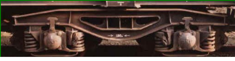
Bogie Y 25 soudé, empattement de 1.80 m, c'est LE bogie le plus utilisé actuellement. Diamètre des roues 920 mm.
