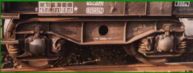
Bogie Y 23 soudé, empattement de 2.00 m, roues de 920 mm, visibles surtout sous les citernes, etc...
